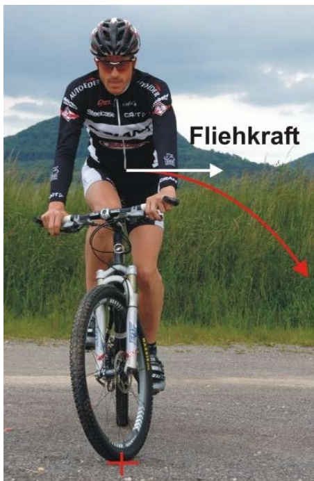
Rechtskurve bei senkrechter Haltung. Die Fliehkraft kippt den Fahrer nach links außen
